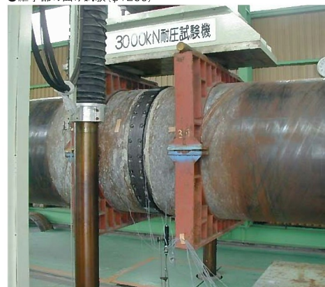
●継手部の曲げ試験(φ1200)
