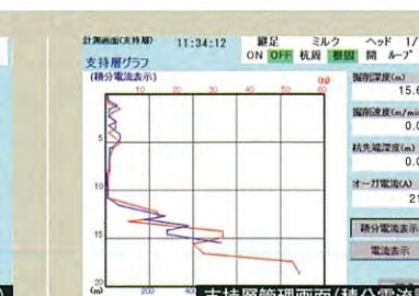
支持層管理画面(積分電流計) 積分電流値により、地盤状況を把握できます。
