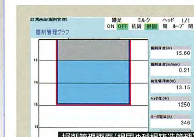
掘削管理画面(根固め球根築造管理) 掘削管理画面によりビジュアル的に根固め液の注入状況を把握できます。
